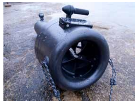
E-Motor, eingebaut in den Unterwasserscooter "Futurum"
